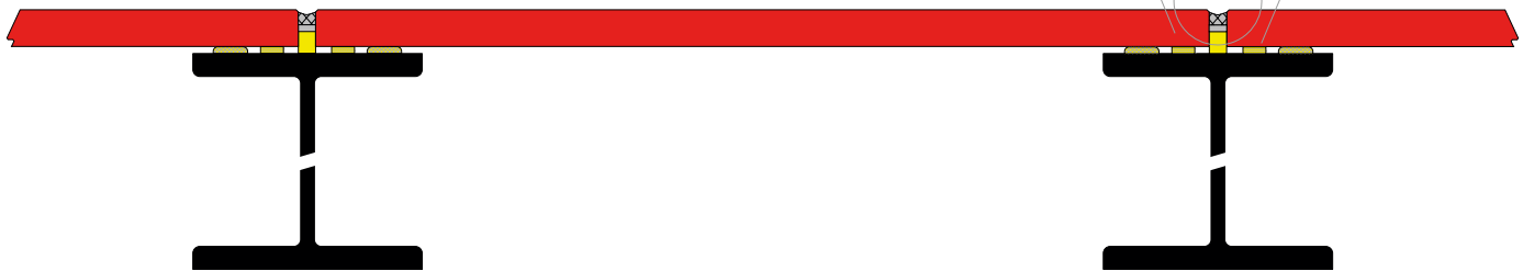
BALKONBODENPLATTE AUF STAHLTRÄGER VERDECKT BEFESTIGT (GEKLEBT)
