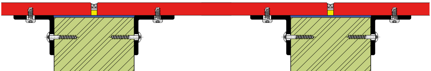
BALKONBODENPLATTE AUF HOLZTRÁM VERDECKT BEFESTIGT (GESCHRAUBT)
