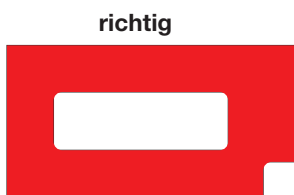
AUSFRÄSUNGEN IN DER FUNDERMAX COMPACT PLATTE
