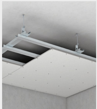
Abgehängte Decke mit Stahl-Unterkonstruktion
